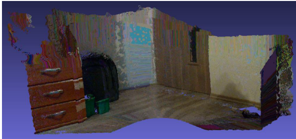
Figura 13.6: Exemplu de imagine reconstruita după aplicarea algoritmului ICP
